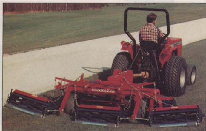
1. 5 or 7 Gang Hyd. Lift P.T.O. Mowers
