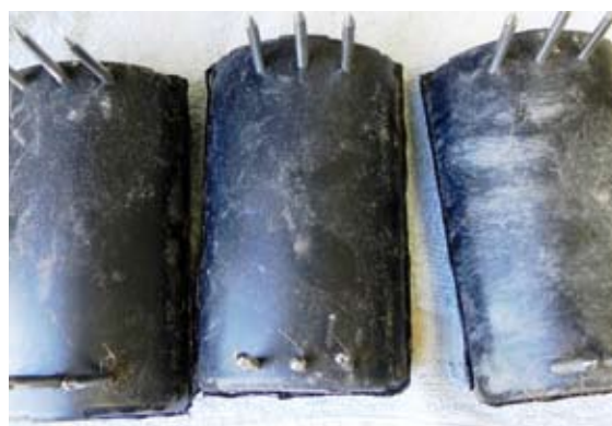
Sensores inalámbricos de humedad instalados en el suelo ayudan a los greenkeepers en las decisiones sobre cuándo y cuánto regar los fairways y roughs.
