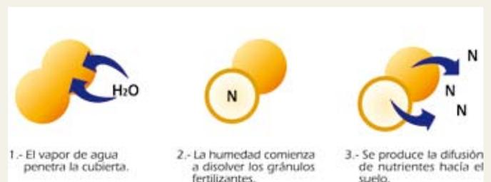
Figura 2: Mecanismo de liberación controlada de un fertilizante encapsulado con polímeros biodegradables.
