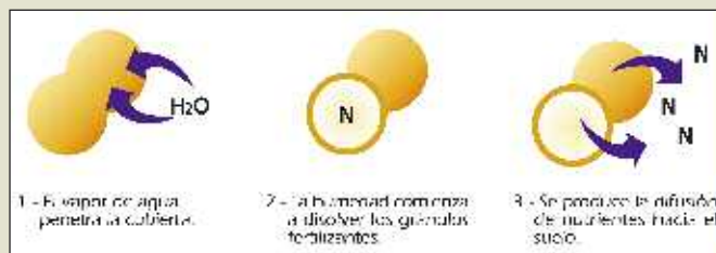
Figura 2: Mecanismo de liberación controlada de un fertilizante encapsulado con polímeros biodegradables
