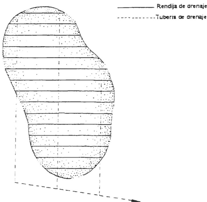
**Esquema de rendijas y tuberías de drenaje en greenes y antegreenes con subsuelos semipermeables.**
