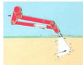
El diseño de paralelogramo exclusivo de Verti-Drain realmente remueve el suelo. Las púas huecas están también disponibles para todos los modelos.
