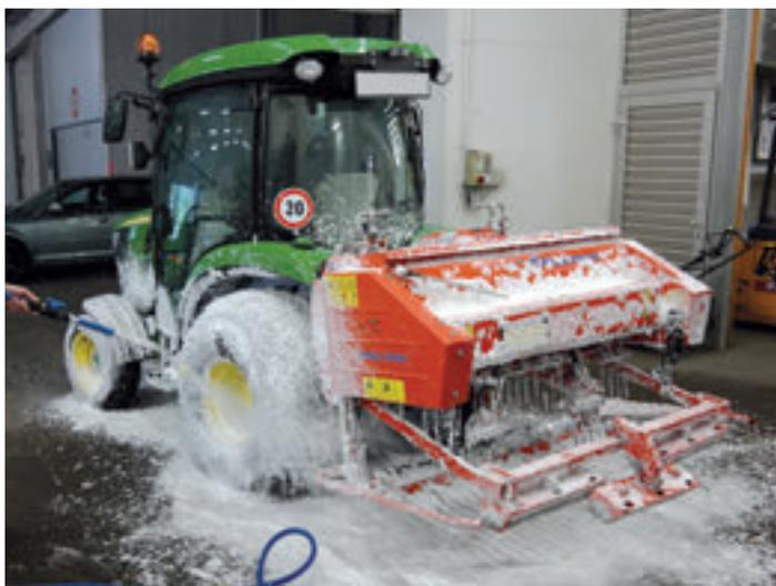
Foto 6. Sistema de desinfección con espuma (foto: grashobber GmbH & Co. KG, Alemania) / Photo.6 Disinfection system with foam (photo: grashobber GmbH & Co. KG, Germany)
