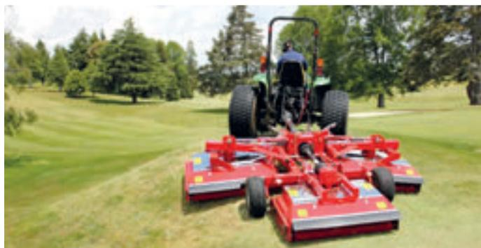
Diseñada con un centro de gravedad bajo, la Snake dispone de plataformas de corte monocasco de 5 mm de espesor. Accionada mediante T.D.F y correas con tensores automáticos, aseguran un funcionamiento constante durante jornadas de 10 horas al día, 5-6 días a la semana, minimizando el tiempo de inactividad, favoreciendo así la productividad y reduciendo los costes de mantenimiento.
