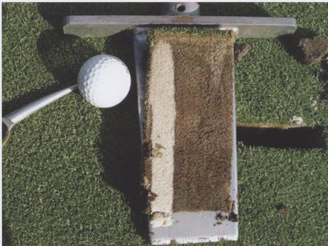
Un putting green indebidamente construido o manejado a menudo requerirá prácticas de manejo complicadas y extensivas para ayudar a que se desempeñe adecuadamente. En este caso, se utilizó una mezcla mal drenada, y la modificación profunda del suelo fue necesaria para mejorar el drenaje interno
