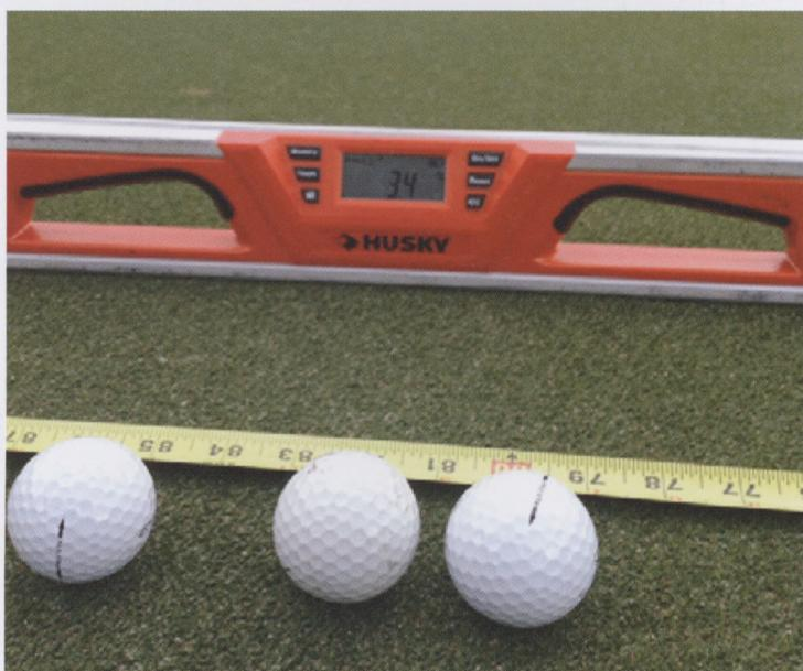
Foto 2. Un nivelador digital proporciona una medida precisa de la pendiente alrededor de una ubicación de un hoyo.
