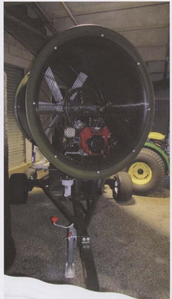
Ventilador con motor de gasolina, para evitar la formación de rocío y reducir así los problemas con los hongos.
