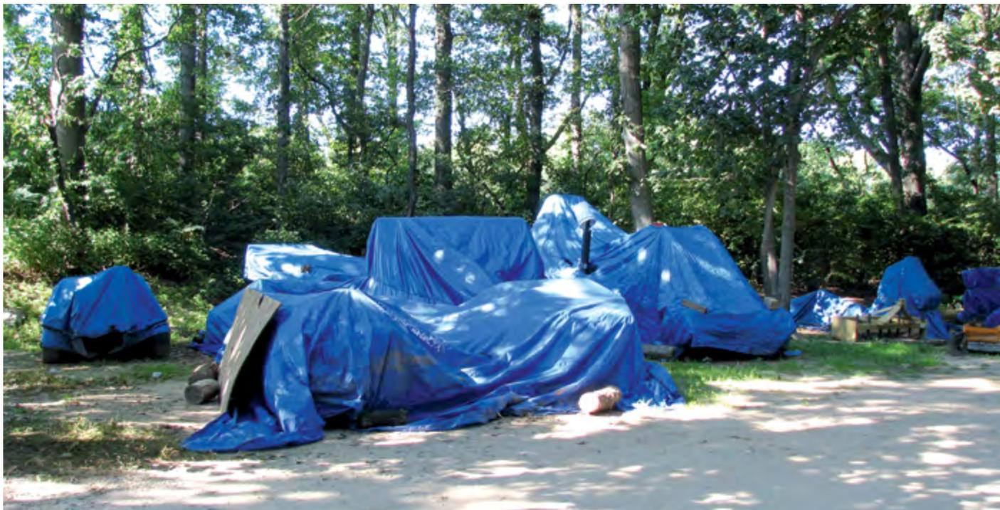
Imagen 1: Los equipos expuestos o parcialmente protegidos de la intemperie tendrán una vida útil más corta y sufrirán más averías y reparaciones costosas que los equipos resguardados en dependencias cubiertas.
