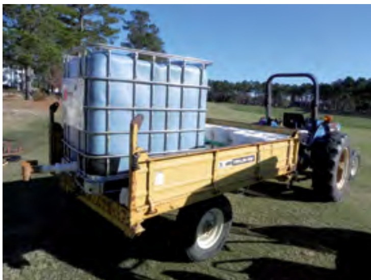
Un tanque agitador pre-mezcla los productos colorantes de césped con agua para llenar rápidamente el pulverizador. Los tanques se pueden mover a cualquier ubicación en el campo de golf para acelerar las operaciones de pulverización
