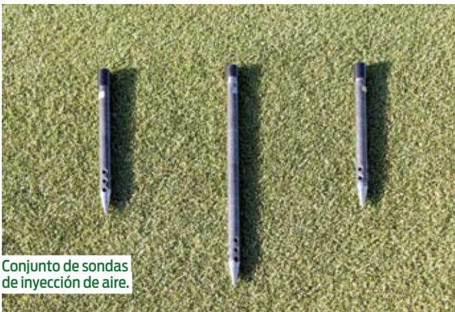
Conjunto de sondas de inyección de aire.
