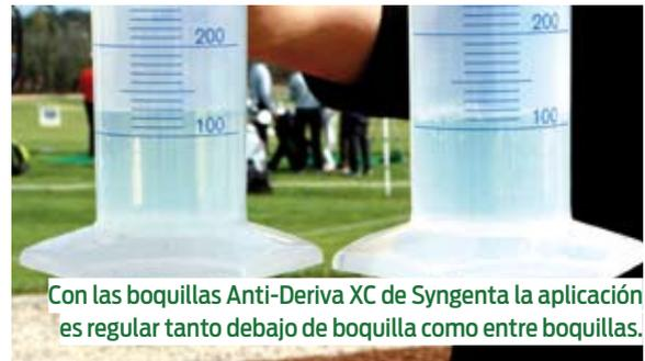
Con las boquillas Anti-Deriva XC de Syngenta la aplicación es regular tanto debajo de boquilla como entre boquillas.
