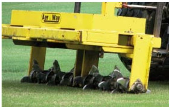
Las pinchadoras o rajadoras pesadas son ideales para ayudar a reducir los problemas de compactación del suelo en un programa de conservación de agua exitoso. Los discos rajan y rompen los suelos compactados a una profundidad de seis pulgadas o más para abrir nuevos canales para el aire, el agua y el enraizamiento.
