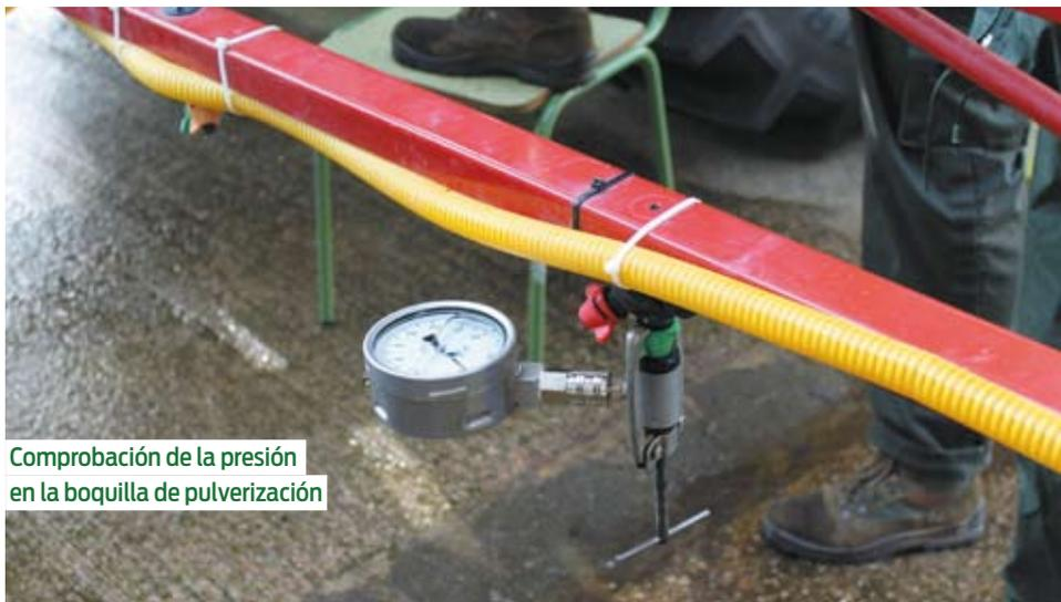
Comprobación de la presión en la boquilla de pulverización
