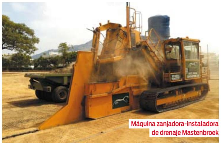
Máquina zanjadora-instaladora de drenaje Mastenbroek
