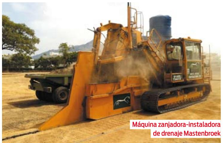
Máquina zanjadora-instaladora de drenaje Mastenbroek
