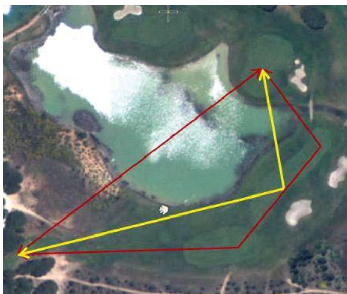
Diferentes opciones para medir un hoyo en curva. Sólo la línea amarilla es la correcta.
