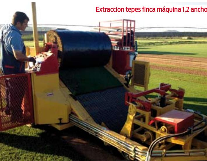
Extracción tepes finca máquina 1,2 ancho
