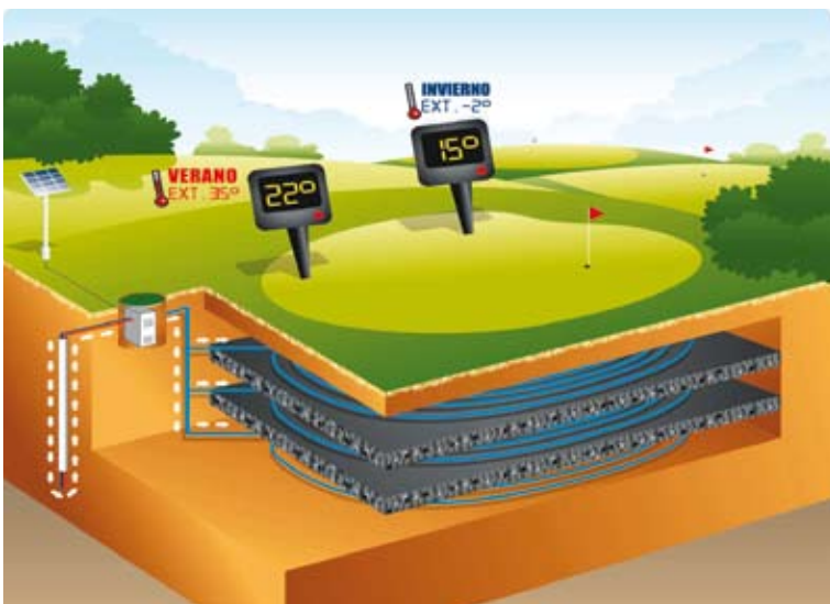
Ilustración 3. Detalle final de la instalación de transmisión de energía geotérmica.
