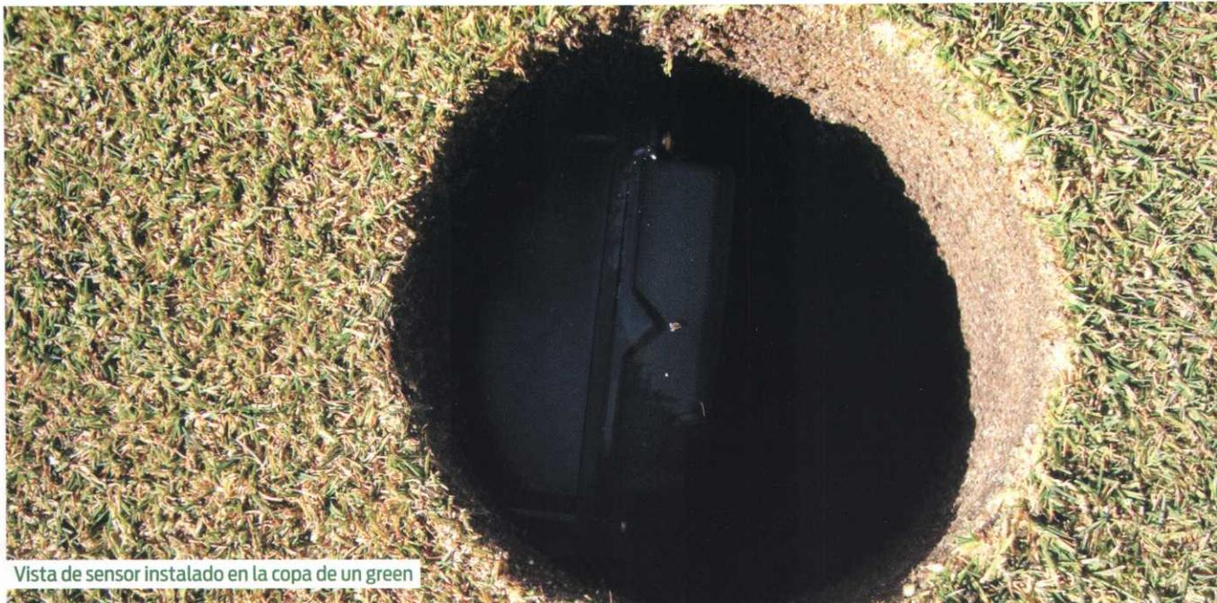
Vista de sensor instalado en la copa de un green
