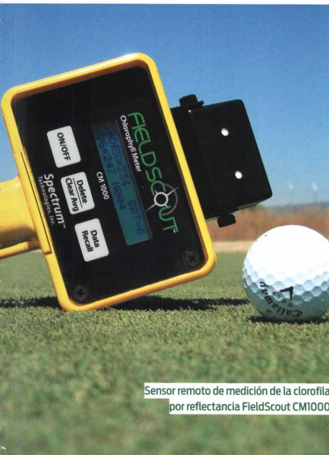
Sensor remoto de medición de la clorofila por reflectancia FieldScout CM1000
