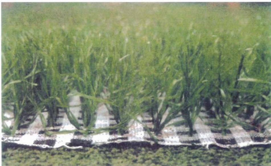
Los sistemas basados en mallas o tejido se implantan debajo de la capa de enraizamiento, sobre el tejido existen hojas de césped artificial y en su estructura se puede sembrar un terreno de juego por cualquiera de los sistemas convenciones proporcionando un soporte de tejido sintético biodegradable.
