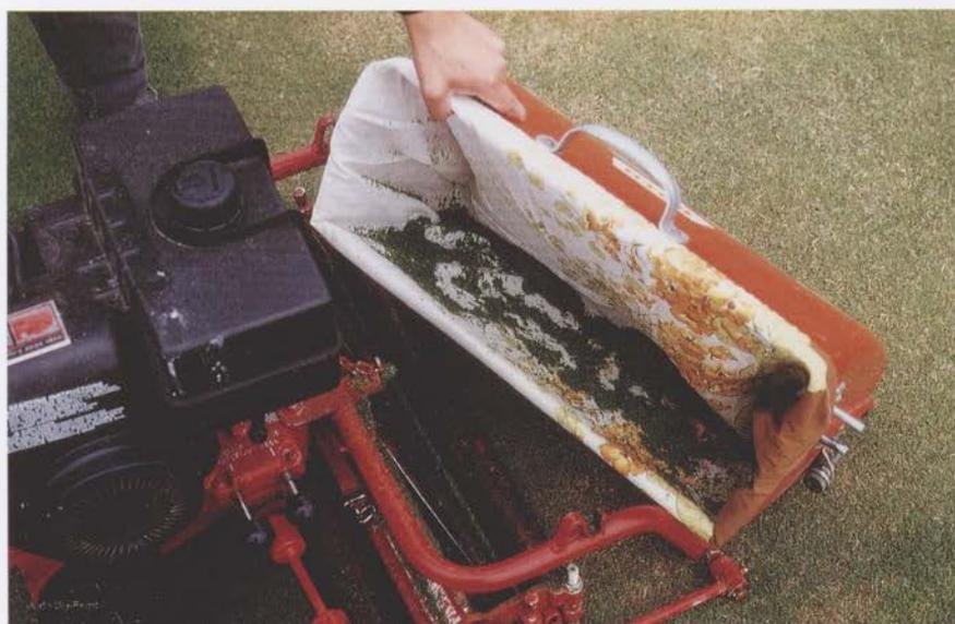
Abbildung 7: Auffangkorb des Spindelmähers mit eingelegtem Leinensack
