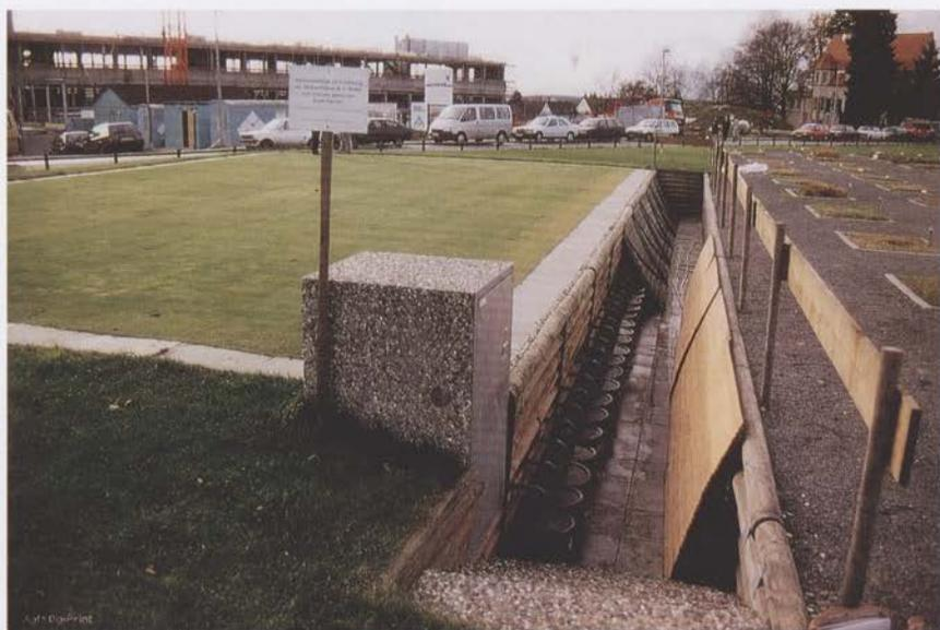
Abbildung 4: Ansicht des begehbaren Grabens mit Sammelgefäßen; in Bildmitte vorn: Waschbetonbehälter zur Unterbringung der Beregnungsschaltanlage
